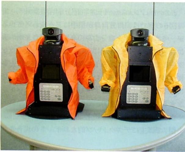
図5 デスクトップジェスチャー実写顔画像投射型分身ロボット端末
