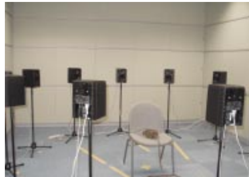
写真2 方向知覚精度試験設備
