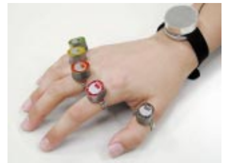
写真2 常時装用型文字入力機構の例 (FingeRing)
