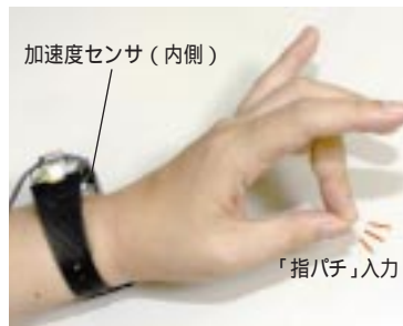
写真1 常時装用型コマンド入力機構 (UbiButton) (「指パチ」動作によって歩きながらでも入力が可能)
