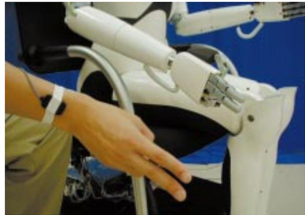
図12 オペレータ手指部電極とヒューマノイドの手指
