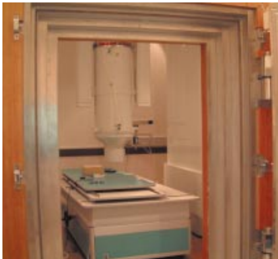
写真2 末梢神経用SQUID生体磁気計測システム外観 (磁気シールドルーム入り口から撮影、中央円筒がデュワー)
