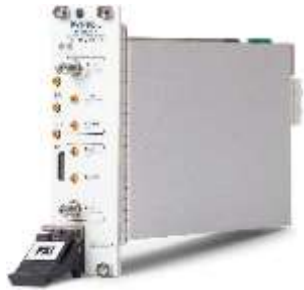
PXIe-5840 6.5 GHz、1 GHz瞬時帯域幅 ベクトル信号トランシーバ (VST)
