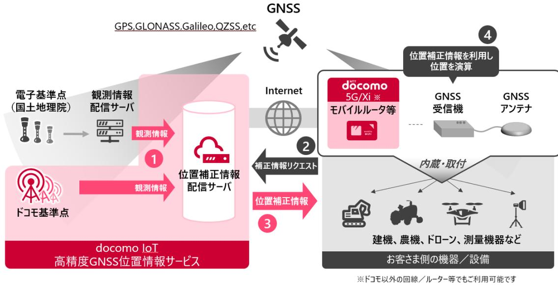
当社は、移動局からの要求に応じて、位置補正情報配信サーバから、電子基準点又はドコモ独自固定局の観測情報を利用して算出した位置補正情報を配信します。本サービスの利用方法の詳細は、当社が別途定める「docomo IoT 高精度 GNSS 位置情報サービス 利用マニュアル」をご確認ください。
