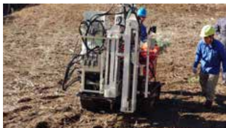
実証実験の様子(タブレットの情報を元に、穿孔(穴あけ)をしている植栽機)
