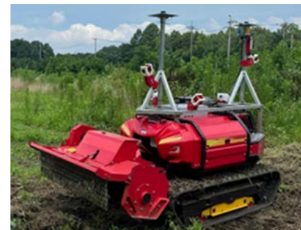
機体に高精度測位衛星システムを搭載した自動運転型下刈機械
