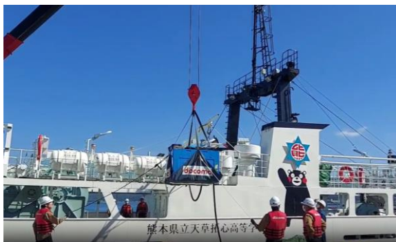
船舶クレーンによる搬入
