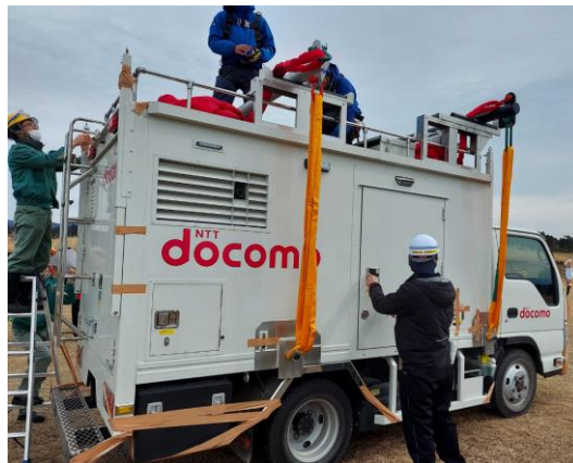
吊り具の取り付け作業
