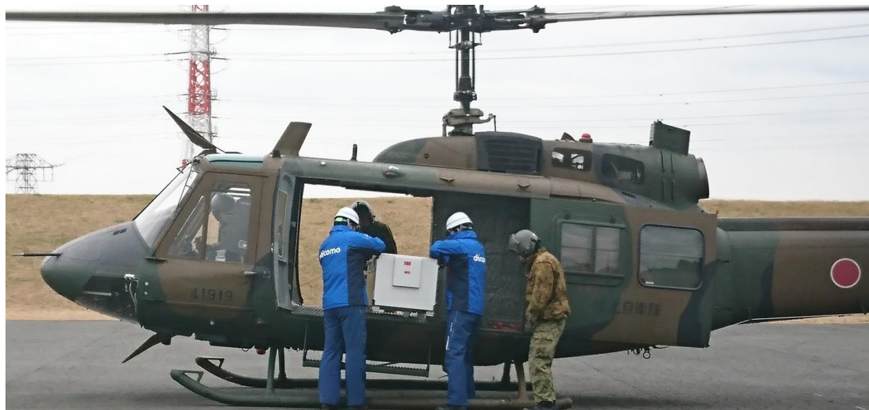
ヘリコプターへの搭載・荷卸し手順を確認（重量バランスも考慮）。
