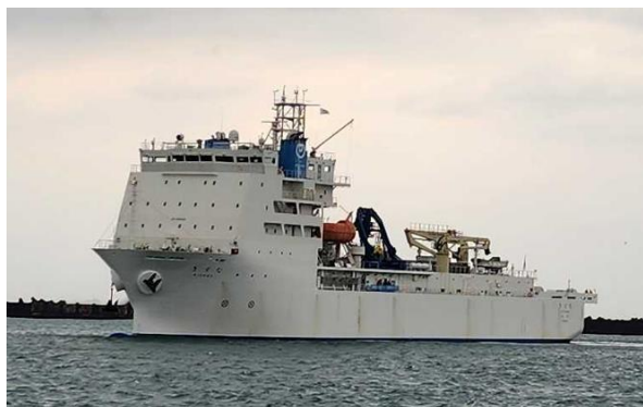
ケーブル敷設船『きずな』
