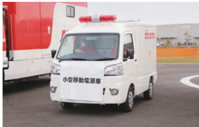
基地局用 小型移動電源車
