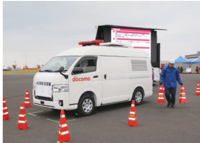
基地局用 中型移動電源車
