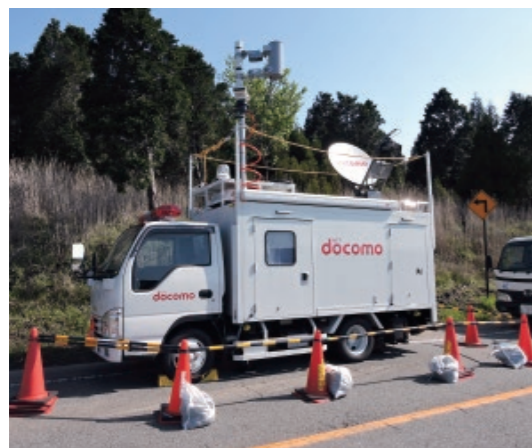
熊本地震で実際に設置された衛星エントランス搭載移動基地局車
