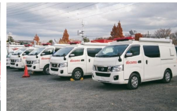
東北地方に集結した移動基地局車と移動電源車
