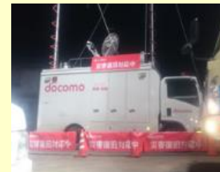
衛星エントランス搭載移動基地局車
