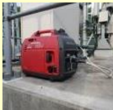
可搬型発電機
