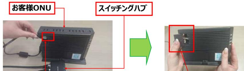
スイッチングハブのポート2に接続されているLANケーブル（50cm）をお客様ONUに差し込みます。
