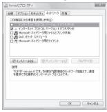
In the [この接続は次の項目を使用します] (Components checked are used by this connection) field, 図 should appear only for [イン ターネットプロトコルパージョン4 (TCP/IPv4)] (Internet protocol version 4 (TCP/IPv4)). Set [QoS パケットスケジューラ] (QoS packet scheduler) according to the instructions of the provider.
